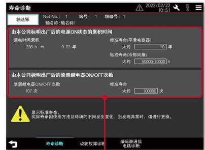
平滑电容器的接通电源时间、浪涌继电器ON/OFF次数一目了然。
