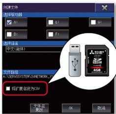
将伺服网络配置的信息输出到文本文件、CSV文件中并以邮件发送,让用户可在远离现场的地方进行确认。
