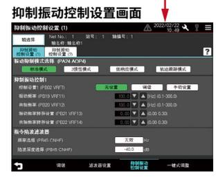
可设置滤波器以抑制机械共振
