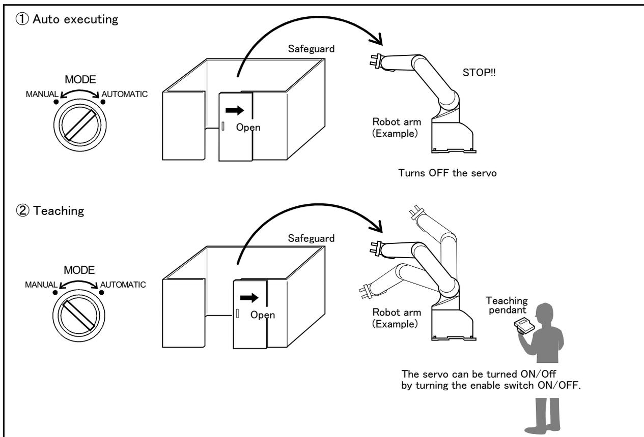
Fig.3-30 : Door switch function
