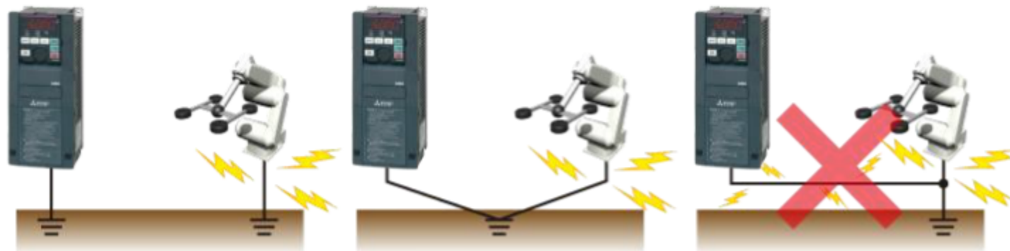
(I) Nezávislé uzemnění (ukostření) – správně
