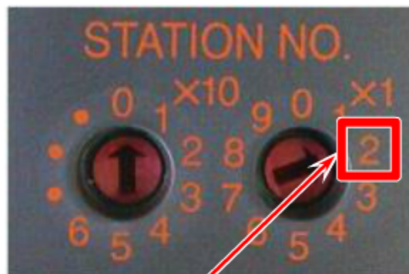
2. állomás: Távoli I/O-állomás (AJ65BTC1-32T, 32 pontos, tranzisztor kimenet)
