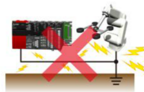
(3) Pembumian umum---Tidak diperbolehkan
