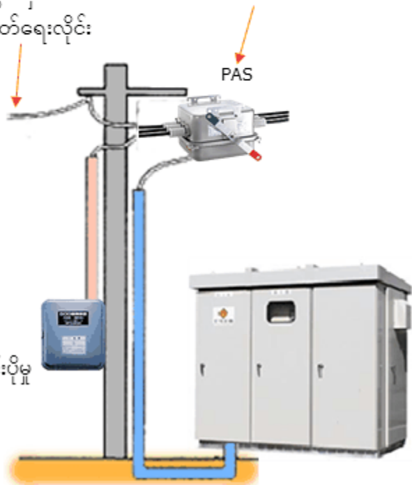
CB ကုမတုံးပုံစံ များသော ဗို့အား ပါဝါလက်ခံ ကိရိယာ
