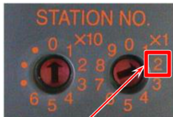
Stacja nr 2: Zdalna stacja wejść/wyjść (AJ65BTC1-32T, 32-punktowa, wyjście tranzystorowe)
