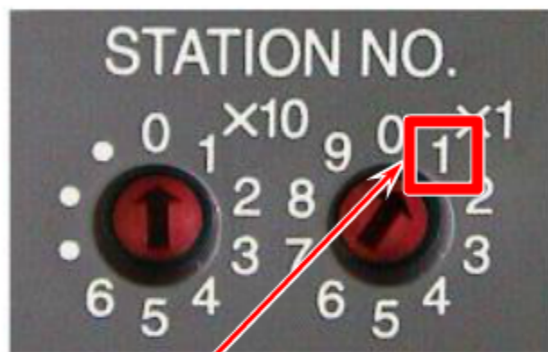
Stacja nr 1: Zdalna stacja wejść/wyjść (AJ65BTB2-16D, 16-punktowa, wejście DC)
