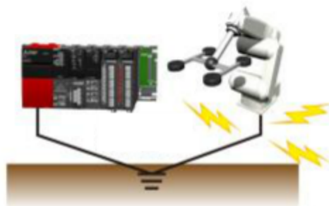
(2) Aterramento compartilhado: Bom
