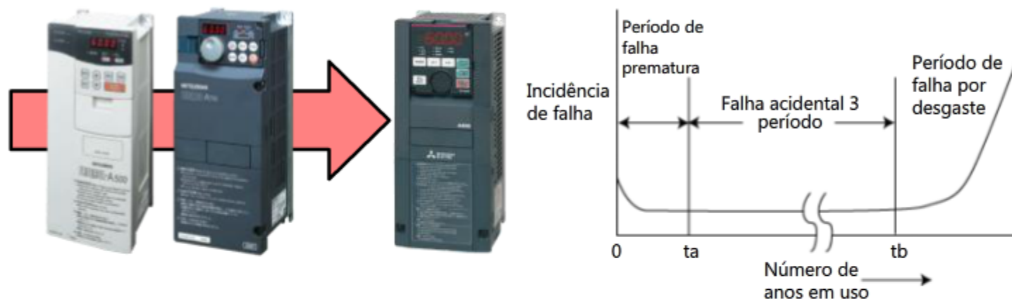
Figura 1. Relação entre o número de anos em uso e incidência de falha
