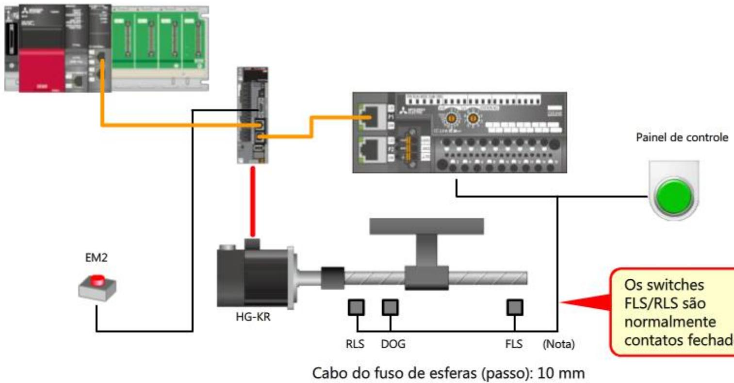
Os switches de limite são instalados nas posições apresentadas abaixo.
