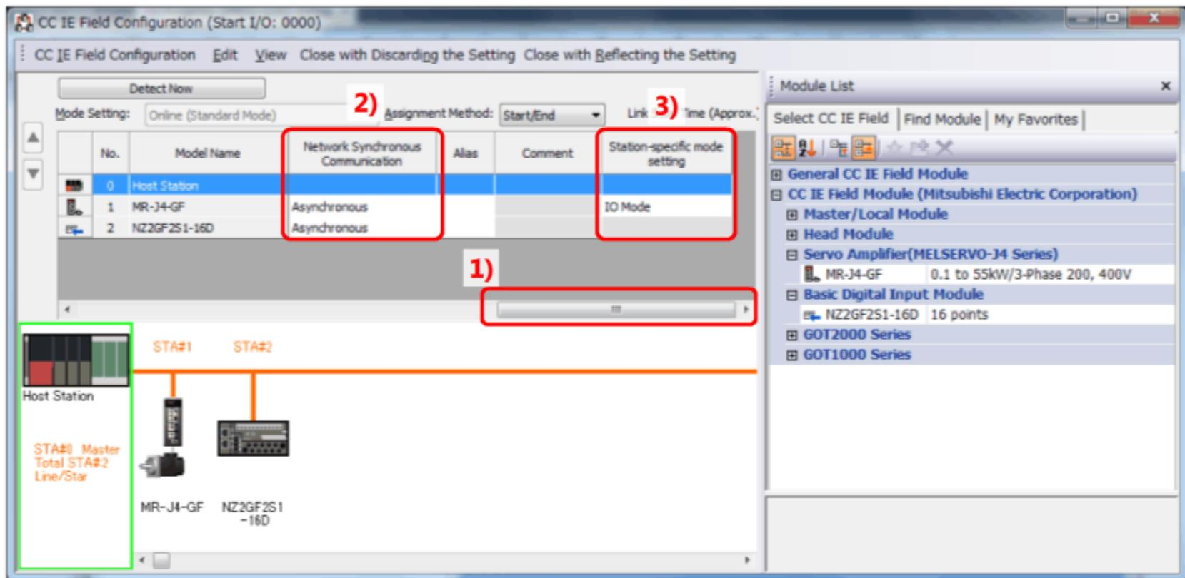
(Nota) Quando se define "Network Synchronous Communication" do módulo de entrada remota como "Synchronous", a definição é restringida de acordo com o número de série do módulo de entrada remota.
