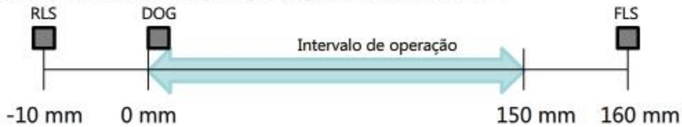
(Nota) Neste curso, o switch do dog de proximidade e o switch de limite de curso são conectados ao módulo de entrada remota, para fins de ilustração. Para melhorar a precisão do retorno à posição inicial, conecte-os diretamente ao servo amplificador.
