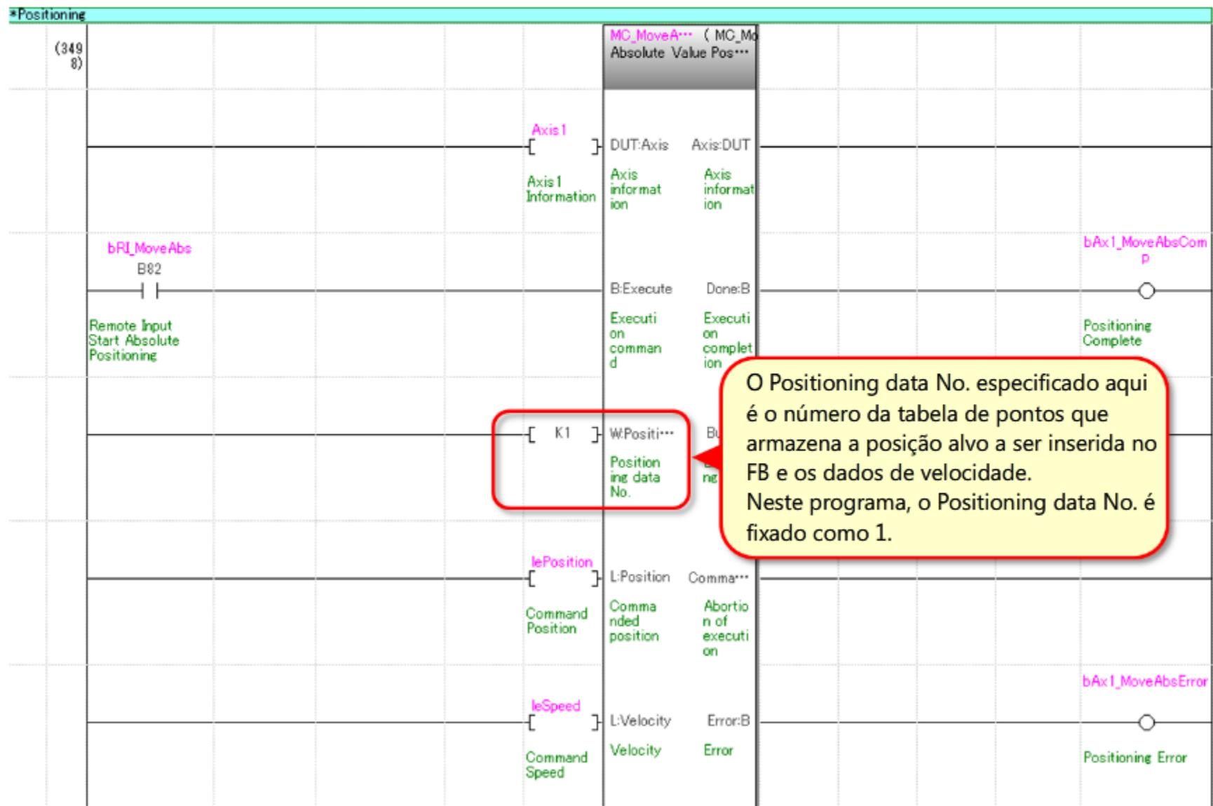
O Positioning data No. especificado aqui é o número da tabela de pontos que armazena a posição alvo a ser inserida no FB e os dados de velocidade. Neste programa, o Positioning data No. é fixado como 1.
