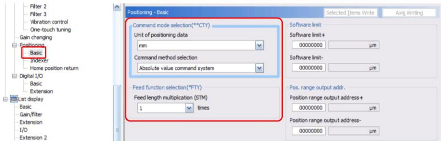
(Nota) O método de comando do valor de incremento não pode ser usado no sistema de detecção do valor absoluto.
