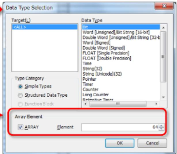
Configure o array do dispositivo de bit como 64 (número de elementos)
