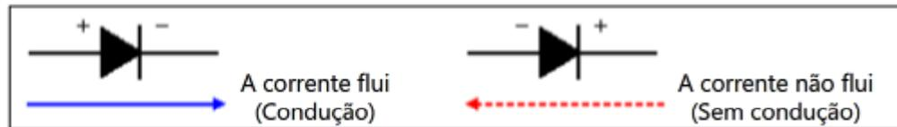
Utilizando essa propriedade, quando uma tensão CA é aplicada em A e B em um circuito retificador, uma tensão também é aplicada em toda a carga na mesma direção.
