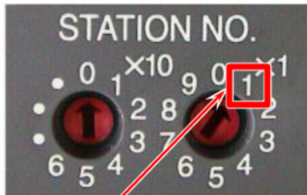
Станция № 1: станция удаленного ввода/вывода (AJ65BTB2-16D, 16 точек, вход постоянного тока)
