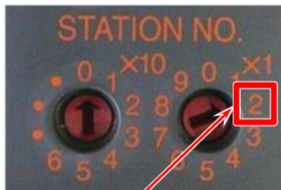
Stanica č. 2: Vzdialená V/V stanica (AJ65BTC1-32T, 32-bodová, tranzistorový výstup)
