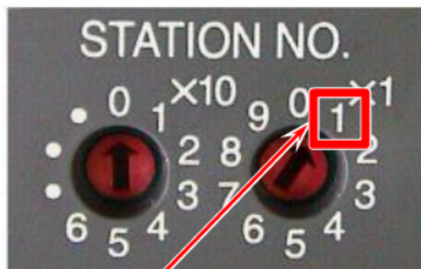
Stanica č. 1: Vzdialená V/V stanica (AJ65BTB2-16D, 16-bodová, vstup na jednosmerné napätie)
