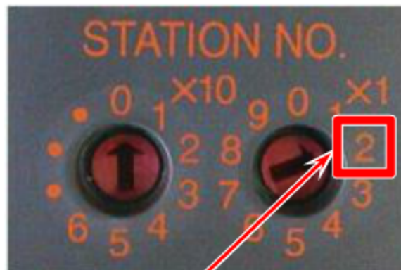
สถานี #2: สถานีรีโมท I/O (AJ65BTC1-32T เอาท์พุททรานซิสเตอร์ 32 พอยท์)
