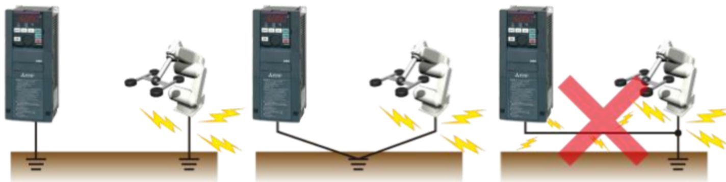
(I) การเดินสายดิน (การต่อสายดิน) แยกต่างหาก...ดี
