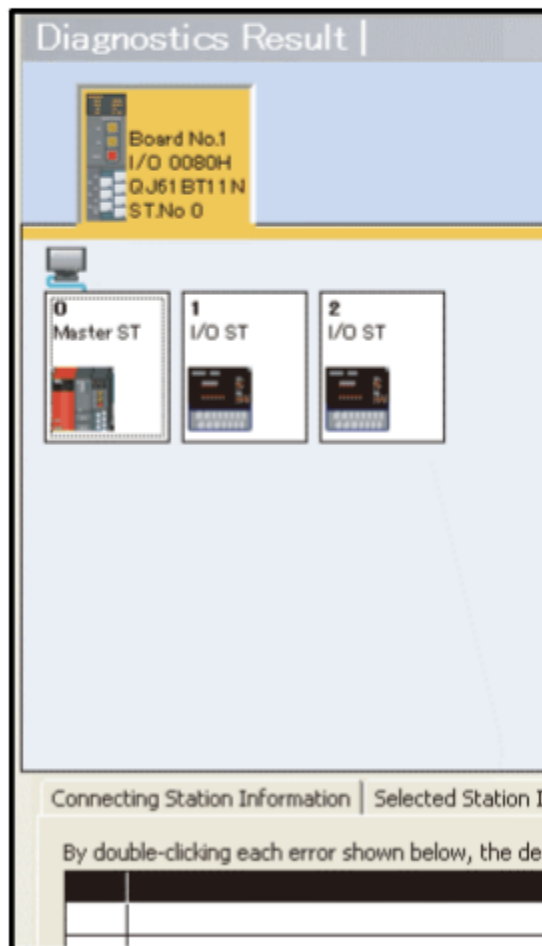
Màn hình CC-Link Diagnostics (Chẩn đoán CC-Link)
