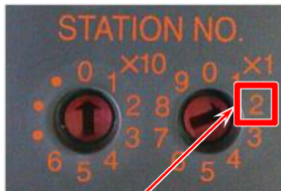
Trạm #2: Trạm I/O từ xa (AJ65BTC1-32T, 32 điểm, đầu ra transistor)
