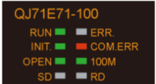
Ví dụ về hiện trạng BẬT của đèn chỉ báo LED "COM.ERR" (LỖI COM)
