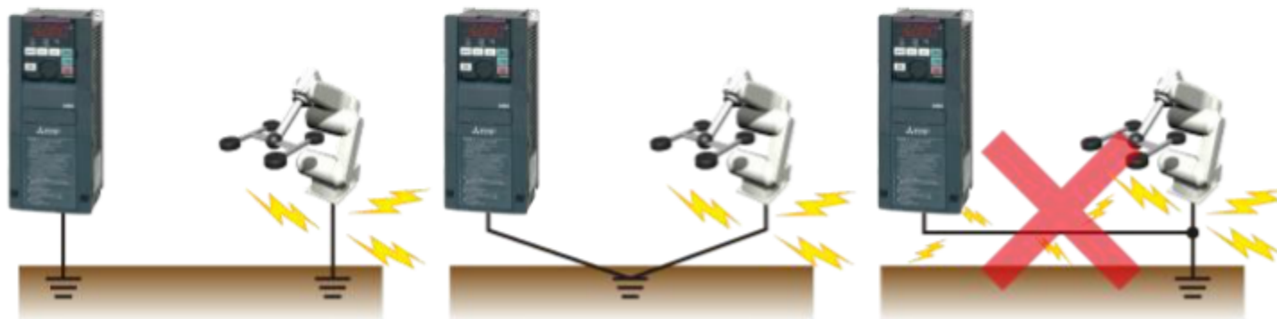
(I) Tiếp đất (nối đất) độc lập...Tốt
