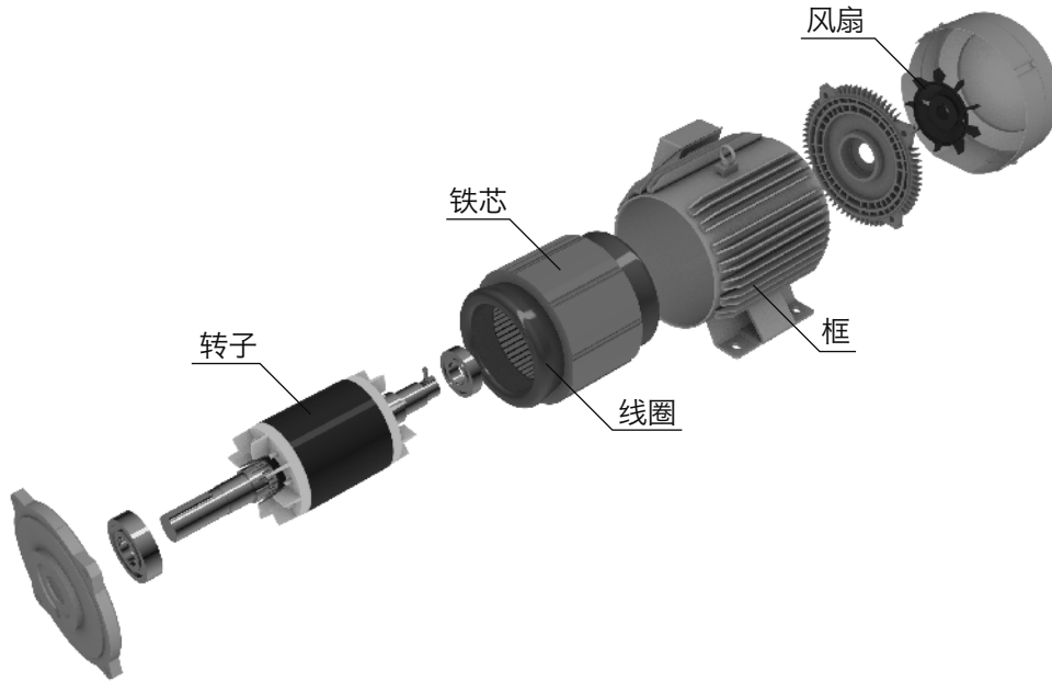
电机的构造
