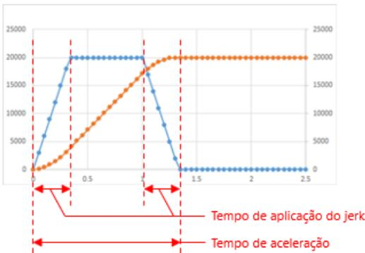
Quando se define J = 0 [μm/s<sup>3</sup>], o padrão de velocidade muda para a aceleração/desaceleração trapezoidal.
