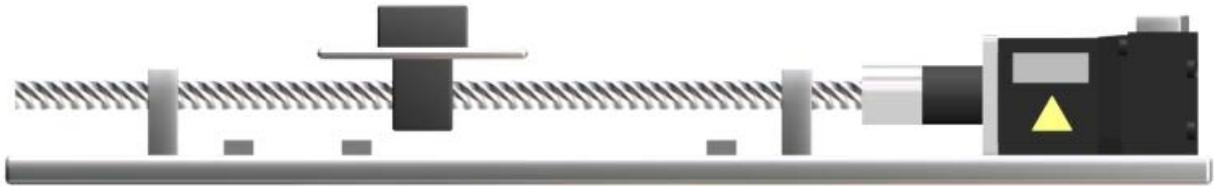
A ativação da chave de JOG com rotação de avanço move a operação na direção de endereço crescente, e sua desativação interrompe a operação.
