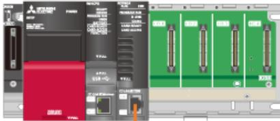
Configure o quarto octeto dos endereços IP do módulo de entrada remota e do servo amplificador com os botões rotativos.
