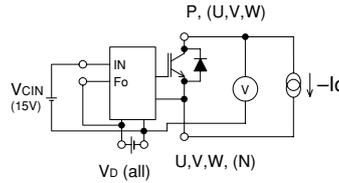
Fig. 2  $V_{EC}$  Test
