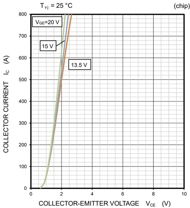
COLLECTOR-EMITTER SATURATION VOLTAGE
