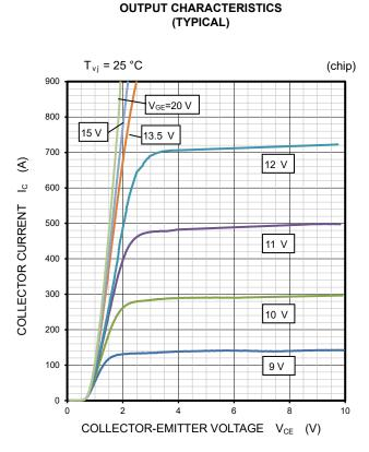
COLLECTOR-EMITTER VOLTAGE CHARACTERISTICS (TYPICAL)
