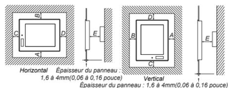
Laissez les espaces entre le GOT et les autres dispositifs en fonction des dimensions contenues dans le tableau suivant. Les valeurs entre parenthèses s'appliquent au cas où aucun dispositif générant des émissions sonores (comme un contacteur) ou de la chaleur n'est installé près du GOT. Toutefois, maintenez la température ambiante du GOT à 55°C ou moins.
