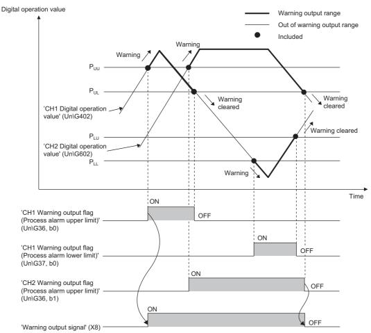
P<sub>UU</sub>: Process alarm upper upper limit value  $\mathsf{P}_\mathsf{UL} : \mathsf{Process}$  alarm upper lower limit value
