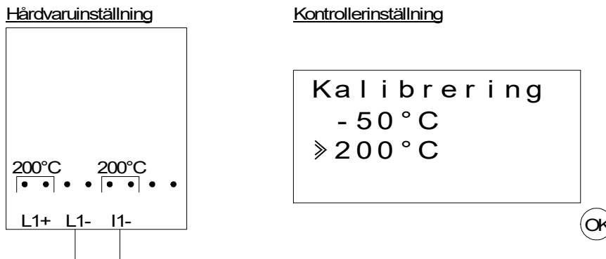
Figur 12.7: Avstämning av förstärkningen för AL2-2PT-ADP
