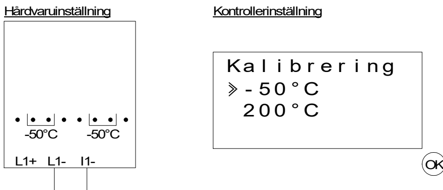
Figur 12.5: Avstämning av offset för AL2-2PT-ADP
