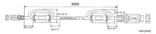
Fig.1-5: USB cable (MR-J3USBCBL3M)
