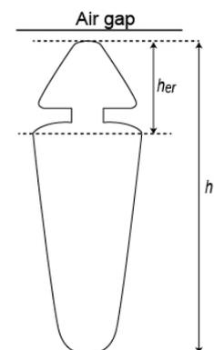
Fig. 1 Rotor slot
