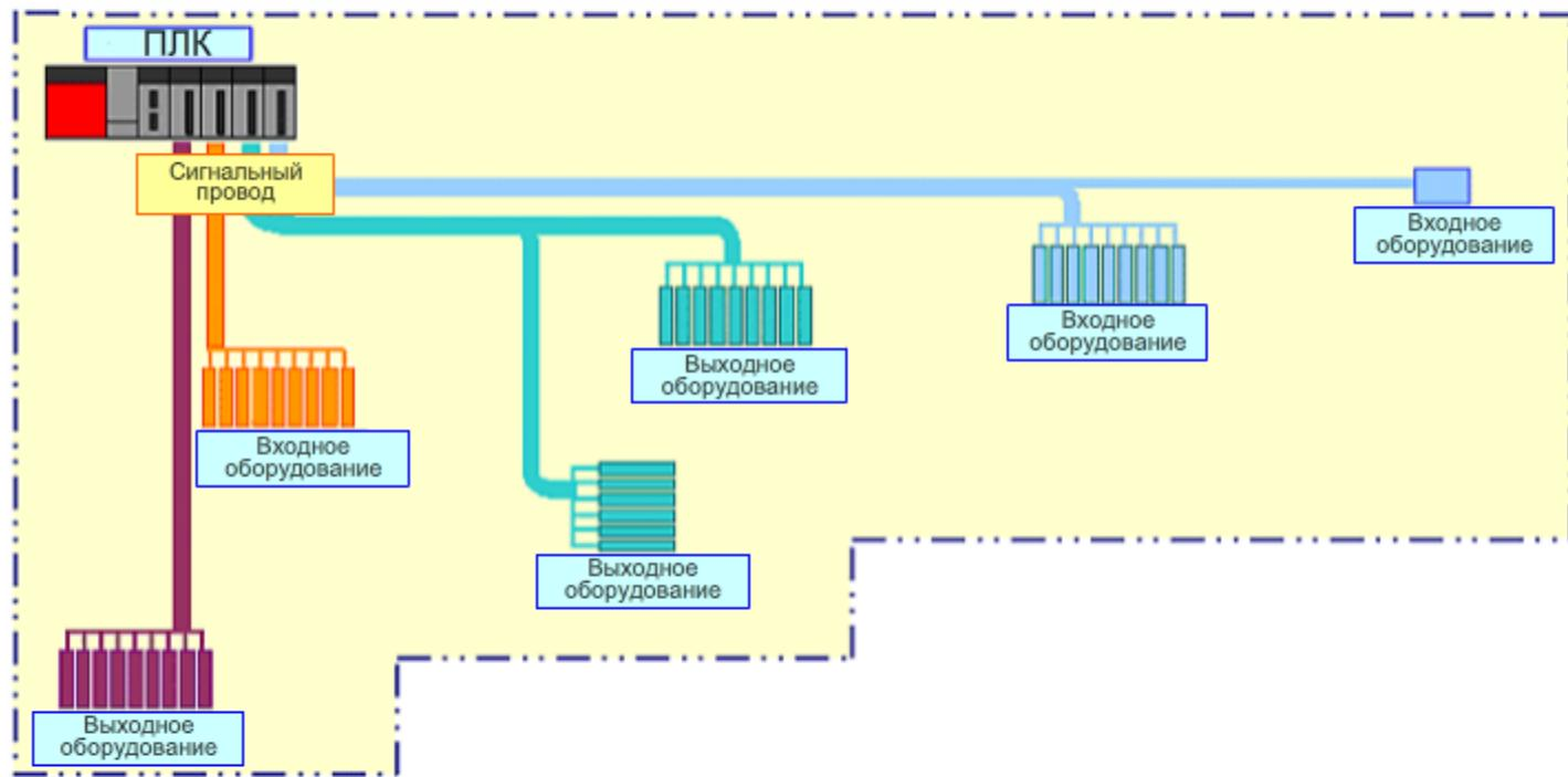
Одним из путей решения этой задачи является установка модулей ввода/вывода в непосредственной близости к датчикам и исполнительным механизмам и соединение ПЛК с этими модулями коммуникационным кабелем для коллективного обмена сигналами ввода/вывода.
