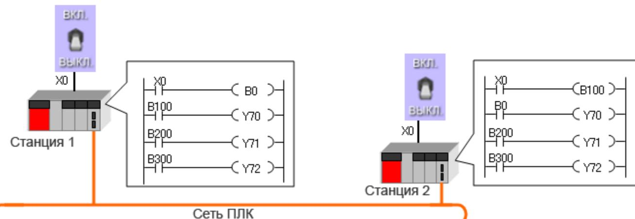
Когда переключатель "Х0" на ПЛК станции 1 устанавливается в положение ВКЛ., --Select-- "В0" переходит в состояние ВКЛ.
