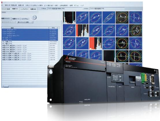
*El analizador de datos en tiempo real (izquierda) se ejecuta en la PC industrial Mitsubishi Electric "MELIPC" (derecha), donde recopila y analiza datos y realiza diagnósticos.*
