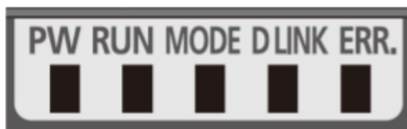
LEDs de módulo remoto do tipo bloco
