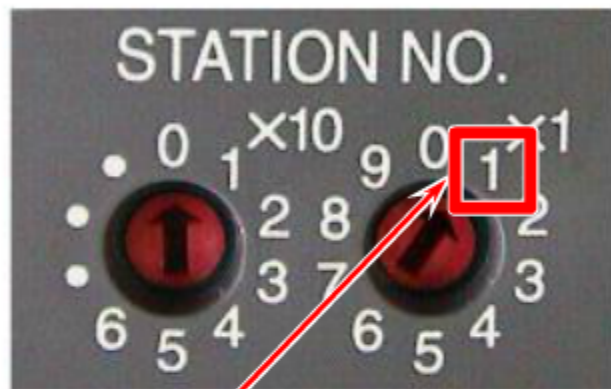
Nº da estação 1: Estação de I/O remota (AJ65BTB2-16D, 16 pontos, entrada CC)
