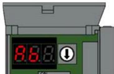
Verifique o status de desativação do servo com o visor LED (Ab) do servo amplificador.
