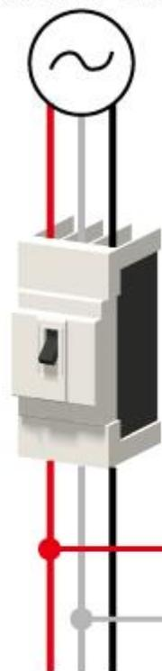
Disjuntor de caixa moldada (MCCB)
