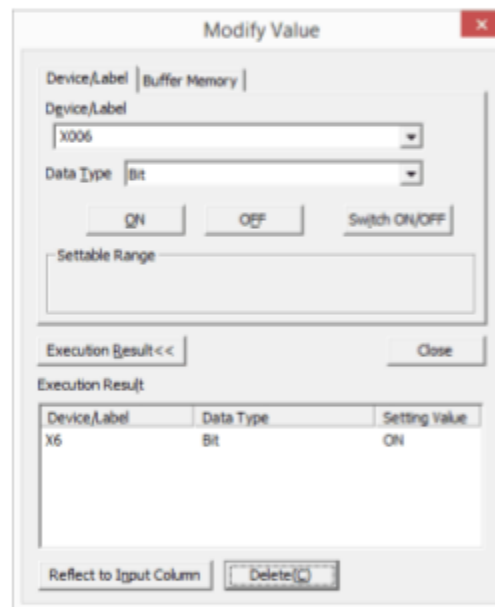
Obrazovka Modify Value (Úprava hodnoty) (séria MELSEC-F)
