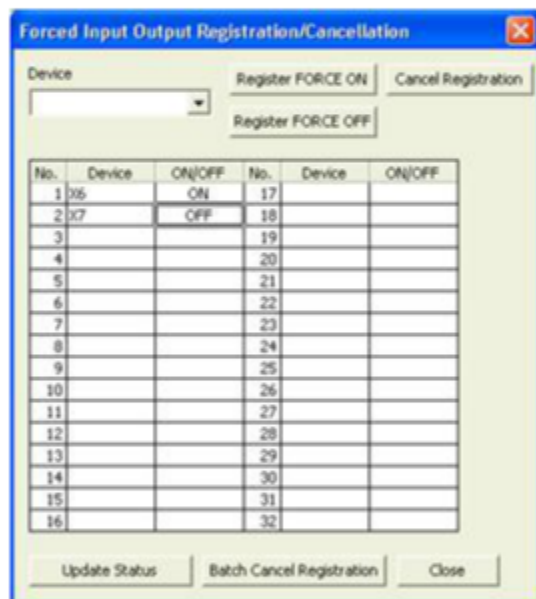
Obrazovka forced Input Output Registration/Cancellation (Registrácia/zrušenie núteného vstupu/výstupu) (séria MELSEC-Q a MELSEC-L)
