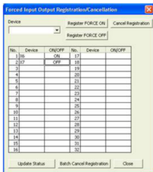
Pantalla Forced Input Output Registration/Cancellation (Registro/Cancelación de Entrada/Salida Forzada) (Series MELSEC-Q y MELSEC-L)
