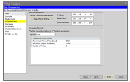
Se necesita instalar un driver de USB antes de que un controlador del robot y una computadora personal se conecten a través de USB.
