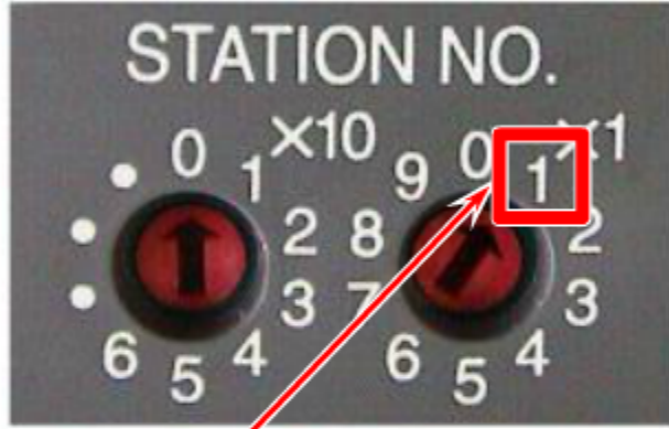
İstasyon no. 1: Uzak I/O istasyonu (AJ65BTB2-16D, 16 noktalı, DC giriş)
