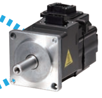
(4) Servo Motor จะตรวจจับข้อมูลตำแหน่งปัจจุบันผ่าน Encoder (ชุดตรวจจับ) และส่งต่อไปยัง Servo Amplifier Servo Amplifier จะเปรียบเทียบคำสั่งกับค่าที่ตรวจจับได้ และออกคำสั่งเพื่อให้ข้อผิดพลาดระหว่างสัญญาณเกิดขึ้นน้อยที่สุด * สิ่งนี้เรียกว่า "การควบคุมแบบป้อนกลับ"
