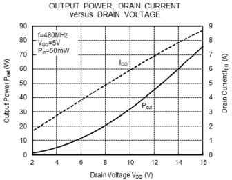
OUTPUT POWER versus DRAIN VOLTAGE
